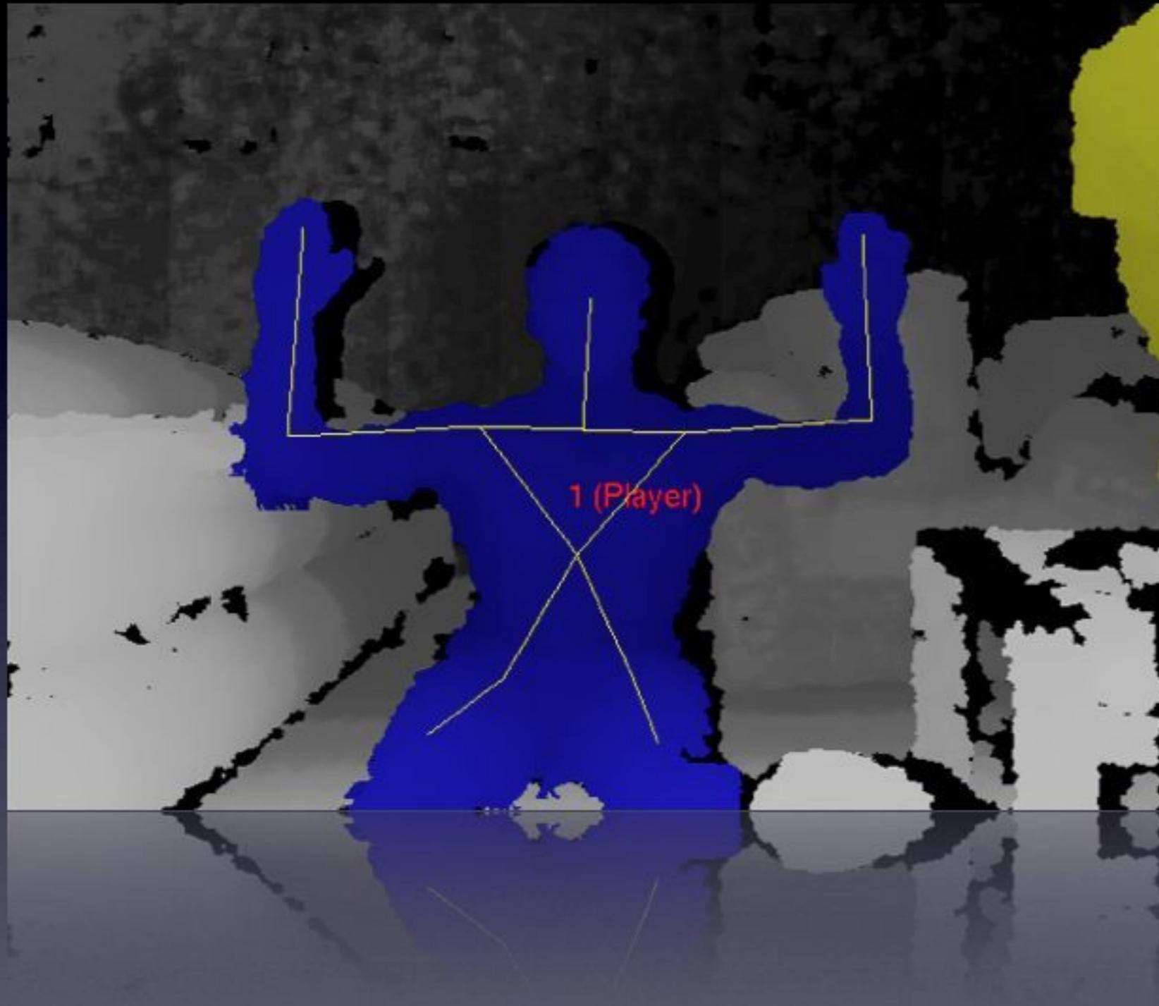
La Y-Pose è una posizione necessaria per consentire al sistema di identificare correttamente il corpo e i suoi segmenti.
